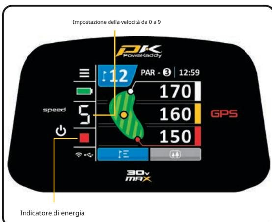
Impostazione della velocità: ruotare la manopola di controllo per regolare la velocità del carrello da 0 a 9. Premere la manopola di controllo per avviare / mettere in pausa e riprendere la velocità selezionata.
