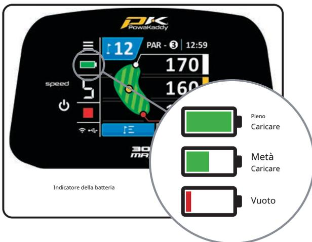
Man mano che avanzi nel giro, la barra interna dell'indicatore si abbasserà. Quando la barra si è completamente spenta, indica che la batteria è scarica. Quando la batteria è nuova, la barra potrebbe cadere solo una piccola quantità durante l'intero round. Man mano che la batteria invecchia, potresti perderne di più.
